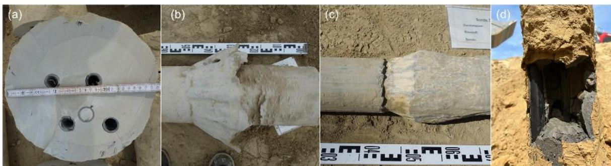
Abbildung 2: Stark vergrößerter Querschnitt einer Erdwärmesonde mit Zentrierhilfe (a); Schirmartige Ausprägung im Verfüllmaterial hervorgerufen durch einen Druckstoß beim Anbau der Verrohrungssegmente (b); Übergang vom verrohrten zum nicht verrohrten Bereich (c); Lunker oberhalb des Schichtübergangs von Löss zu Kalkstein (d)
