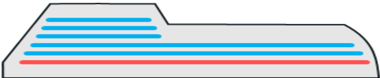
Abbildung 1: Schematischer Längsschnitt durch den Erdwärmekollektor (Darstellung überhöht)
