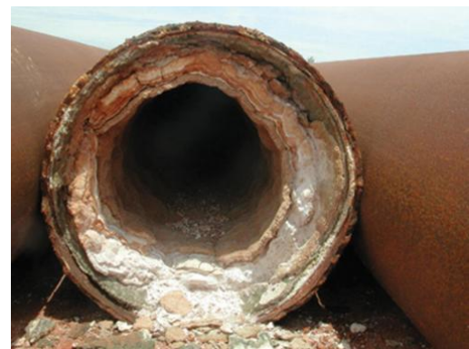
Abb. 4: Scaling in einem Produktionsrohr
